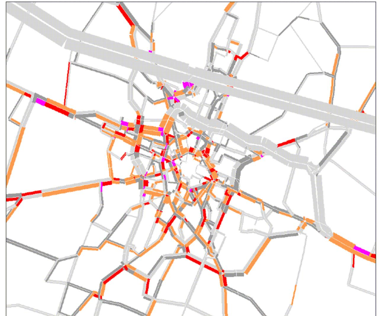
Indicatore dei livelli di congestione sulla rete stradale, stimato tramite il modello di simulazione del traffico
