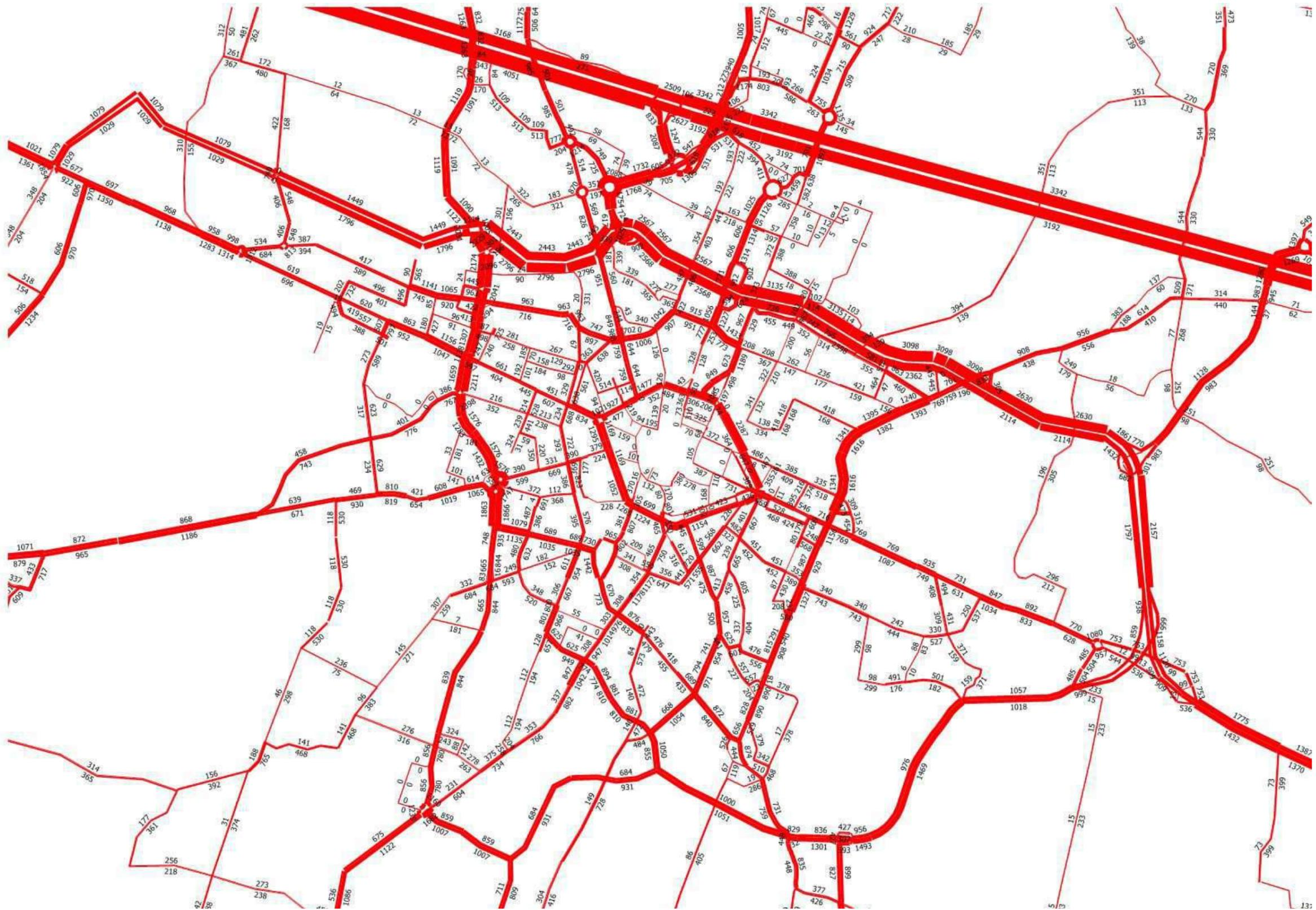
flussi veicolari nell'ora di punta dello scenario definitivo di PUMS nel test di sensitività alle tariffe di sosta (Flussogramma)
