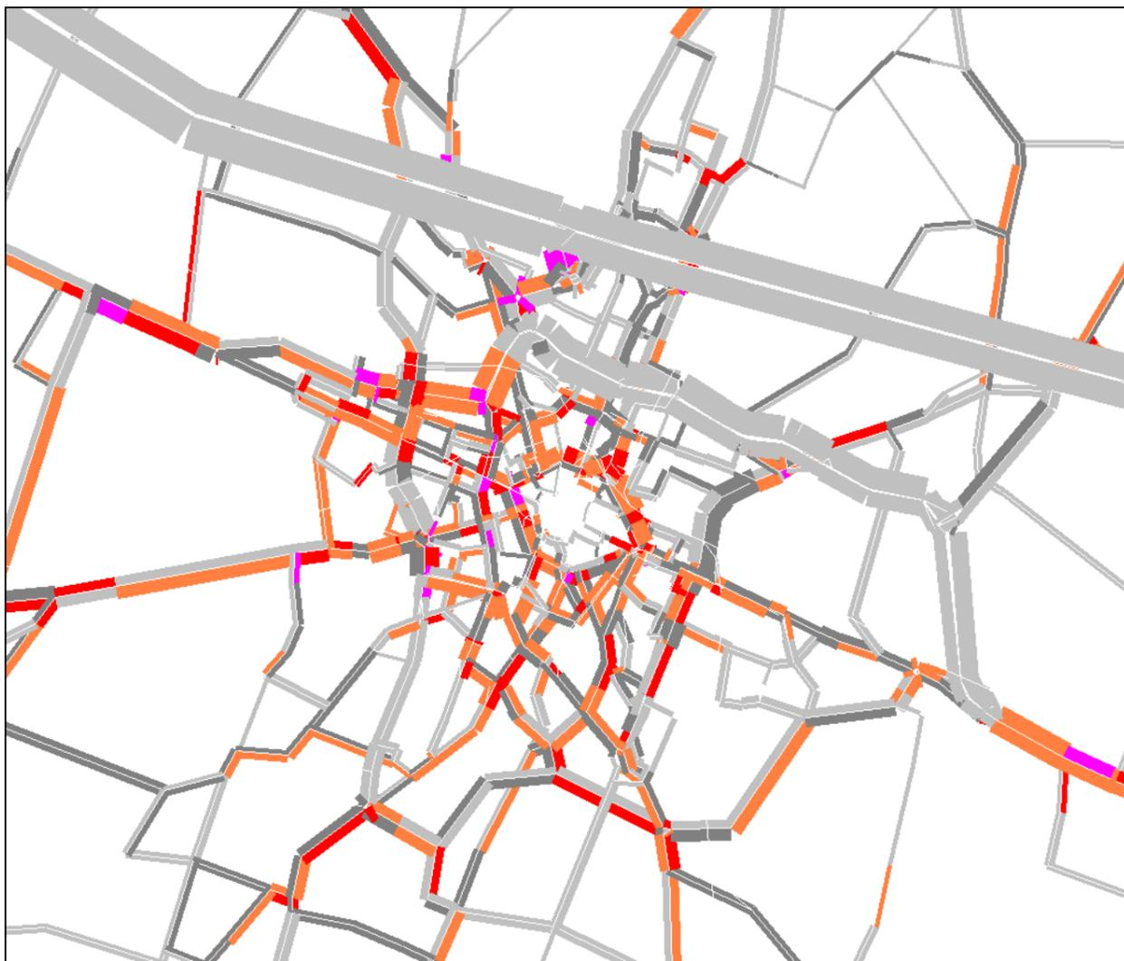
Indicatore dei livelli di congestione sulla rete stradale, stimato tramite il modello di simulazione del traffico
